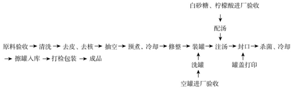
图 1 糖水酥梨罐头生产工艺流程
