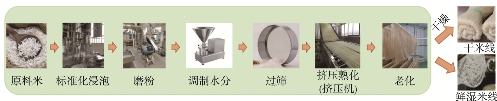
图2 挤压型米线的加工技术
