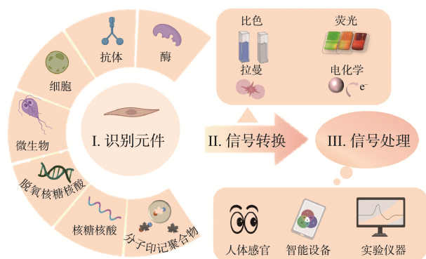
图1 生物传感器的构建示意图
