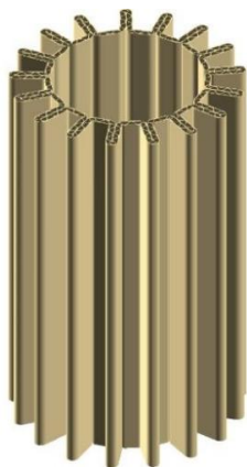
图 4 卡扣折叠结构效果图
