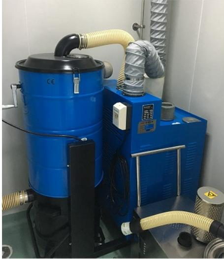
图 2 改造前多列机的除尘设备结构
