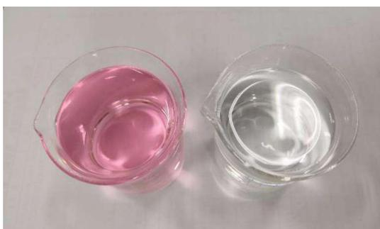
图 5 4%乙酸脱色试验前后颜色变化比较
