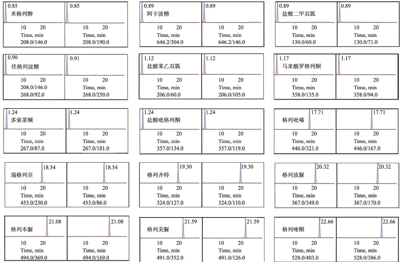
图 1 15 种化学药对照品定量定性离子对的 MRM 色谱图
