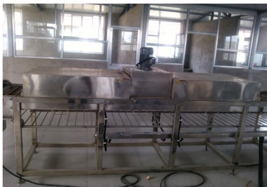
图 3 设备中的热风杀菌部分
