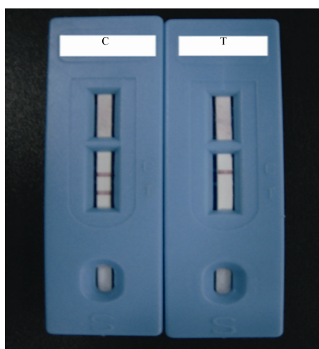
图8 土壤提取液中添加标准毒死蜱后加入侧向层流胶体金试纸条反应(左侧: 空白土壤提取液、右侧: 添加6 µg/mL毒死蜱后土壤提取液)
