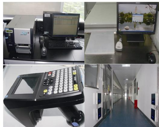
图 3 RFID 打印机与 RFID 读写器
