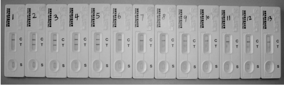
注:1:空白对照;2:鼠伤寒沙门氏菌 ATCC 25241;3:肠炎沙门氏菌 ATCC 13067;4:甲型副伤寒沙门氏菌 ATCC 9150; 5:鸭沙门氏菌 ATCC 9270;6:副溶血性弧菌 ATCC 17802;7:宋氏志贺氏菌 CMCC(B) 51592; 8:单核细胞增生李斯特氏菌 ATCC 7644;9:小肠结肠炎耶尔森氏菌 CMCC(B) 52207;10:大肠埃希氏菌 ATCC 25922; 11:弗氏柠檬酸杆菌 ATCC 43864;12:产酸克雷伯氏菌 ATCC 43165;13:阴沟肠杆菌 ATCC 700323。
